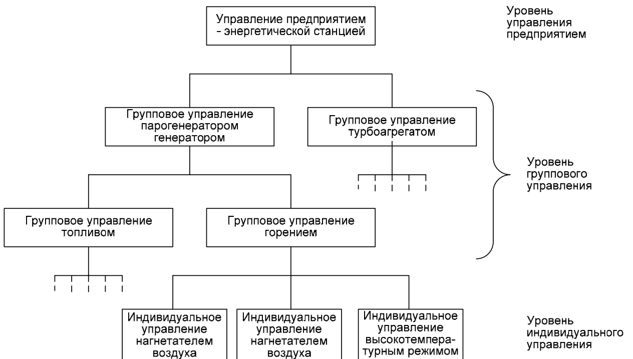
Рисунок 6 – Уровни управления энергетической станцией (ТЭС).
